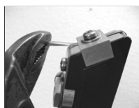
Przeciagnij przewody przy pomocy szczypców i przykręć śrubę
