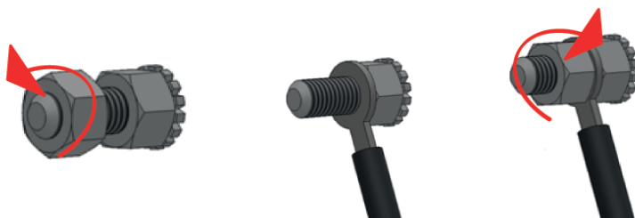
Rys. 7. Podłączenie urządzenia do instalacji wyrównującej potencjały elektryczne.
